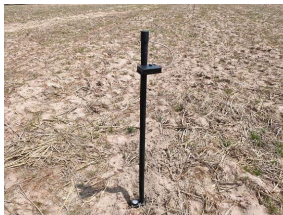
ภาพที่ 9 เครื่องมือที่พัฒนาขึ้น ขณะทำการวัดค่า pH
