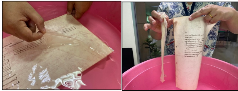
ภาพที่ 5 การทดสอบโดยนำเอกสารที่เคลือบการแบ่งเปียกแต่ละชนิด นำไปแช่น้ำและบันทึกผล
